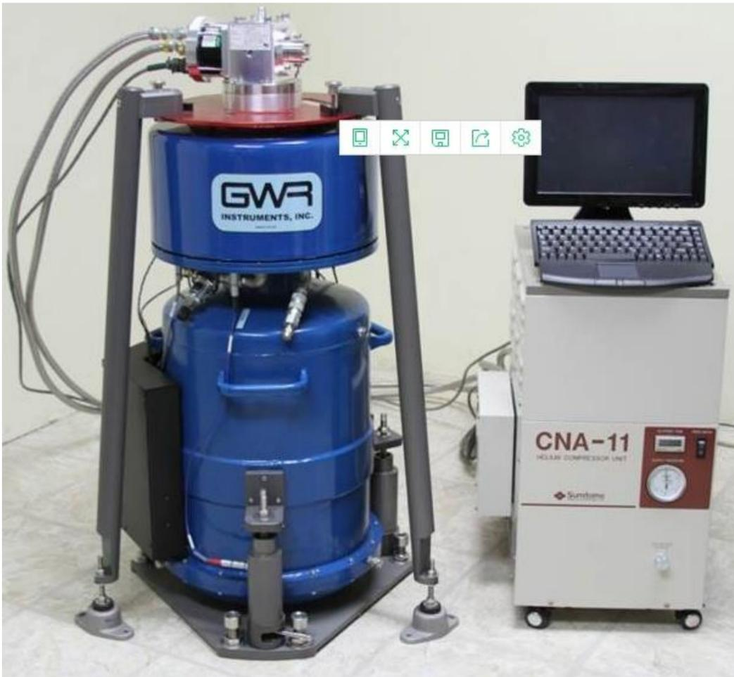
超导重力仪 (Superconducting Gravimeter, SG) 是目前世界上精度最高的相对重力仪，它具有高灵敏度、低噪声、低零漂、响应频率宽等特点，主要用于地幔流变学、固体潮汐，固体地球-海洋-大气相互作用，低频率的地震，火山监测，水文监测以及地球自转等学科领域。
